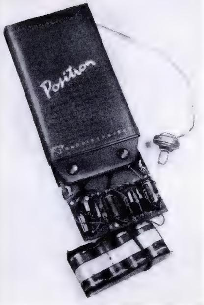
Bild 4. Der Taschenempfänger von unten mit herausgezogener Montageplatte und Batteriekombination
