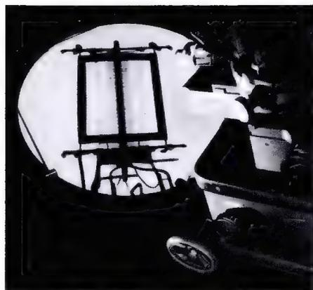
Etwaige Unregelmäßigkeiten im Aufbau der oft sehr kleinen Elektrodenysteme können im stark vergrößerten Schattenbild dem Auge des Prüfers nicht entgehen (aus der Siemens-Röhrenfertigung)
